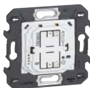
Položka K4500C Komunikační brána s bezdrátovým ovládačem scénářů „doma/mimo domov“
